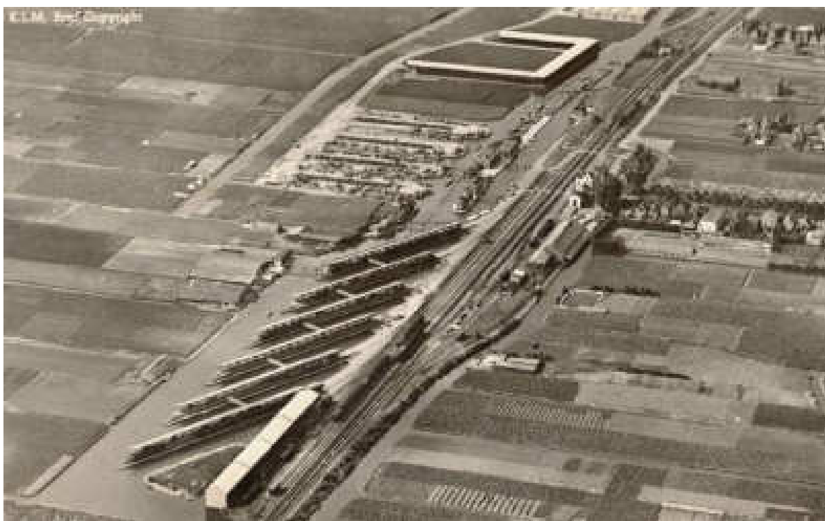
De landtongen bij Bovenkarspel. De landbouwproducten werden vanaf de polderschuiten overgeladen op treinwagons (beeld: collectie luchtfoto's Historische Vereniging Oud Stede Broec)
